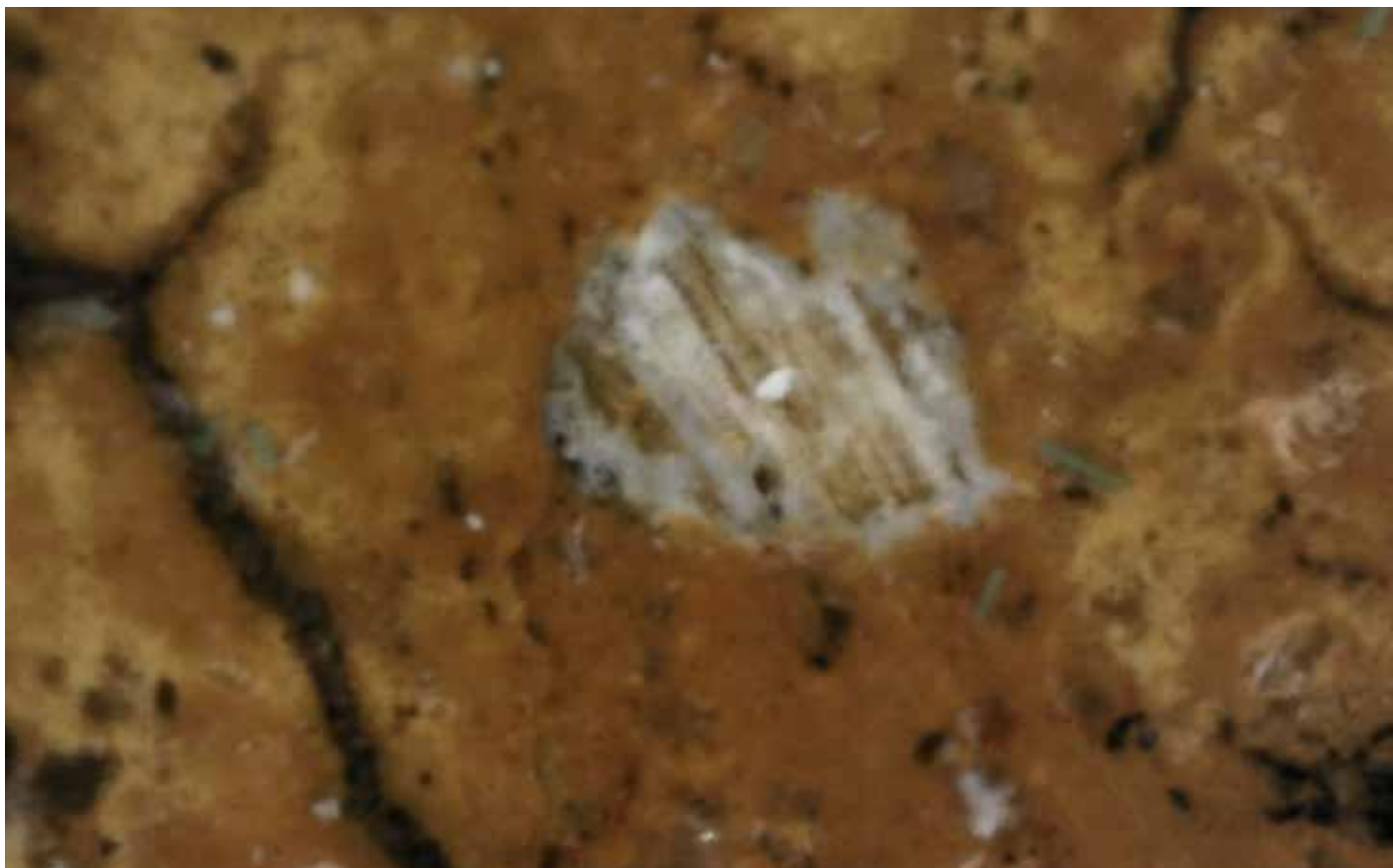
Vindusramme sal, 2.etg. nord. Toppramtre. Innslag av hvitt/grå maling. Åpenbart beliggende under terrakottafargen. s5030-Y50R / 5020-Y40R
