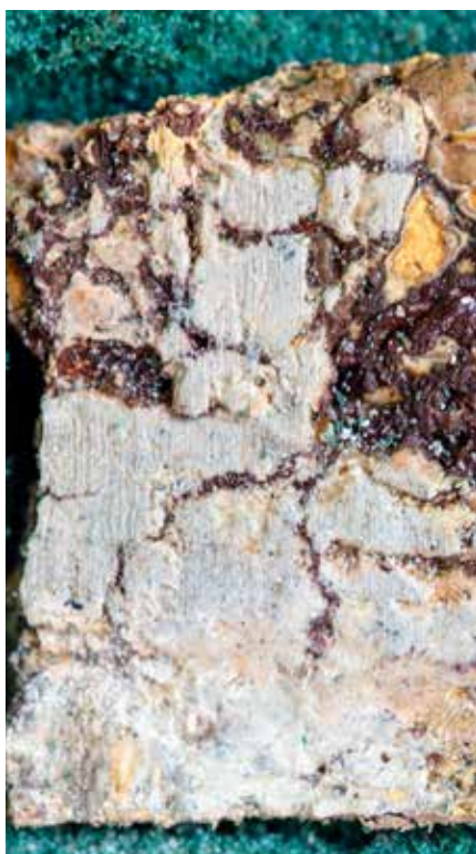
Under: Bakside av malingflak. Lag 1. Nederst skrappt inn i laget. Lag 2 bak.
