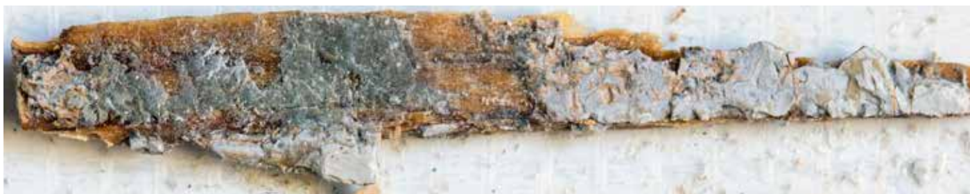
Vindu sal nord 2 etg. Sidegerikt. Prøve 005 0 Treverk 1 Grå grunn 2 s3005-Y50R / s2500-N
