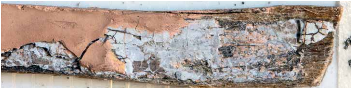
Midtvindu nord 2 etg. Sidegerikt. Prøve 012 0 Treverk 2 Grå grunning 3 s2005-Y50R / s2500-N 3 Oker
