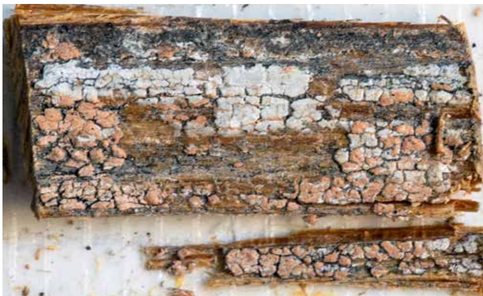
Panel, fragment fra gjenbrukt underligger. Værekspontert felt.
