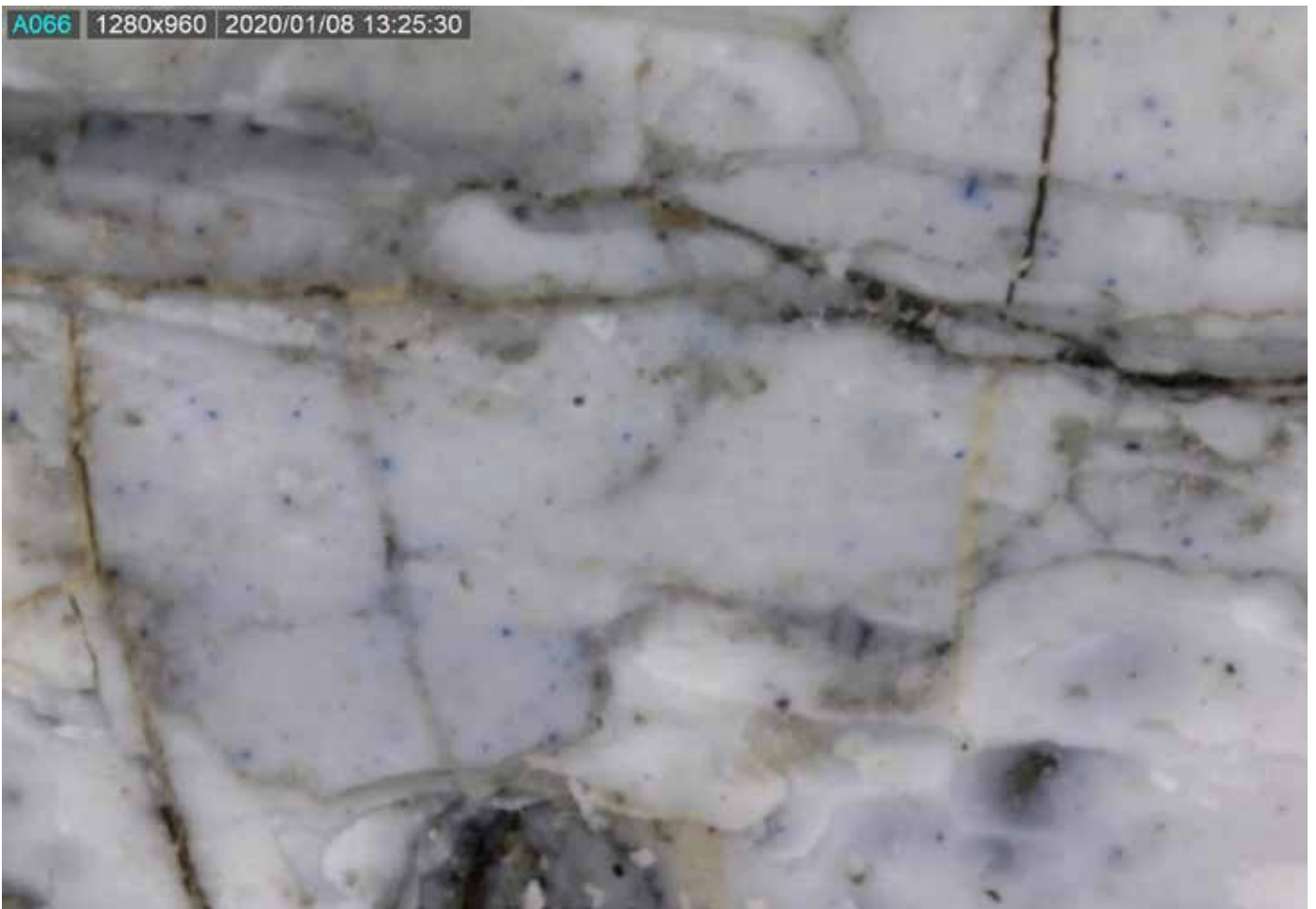
Under: Sokkellist sjikt 3 linoljemaling. Lys grå / hvit.
