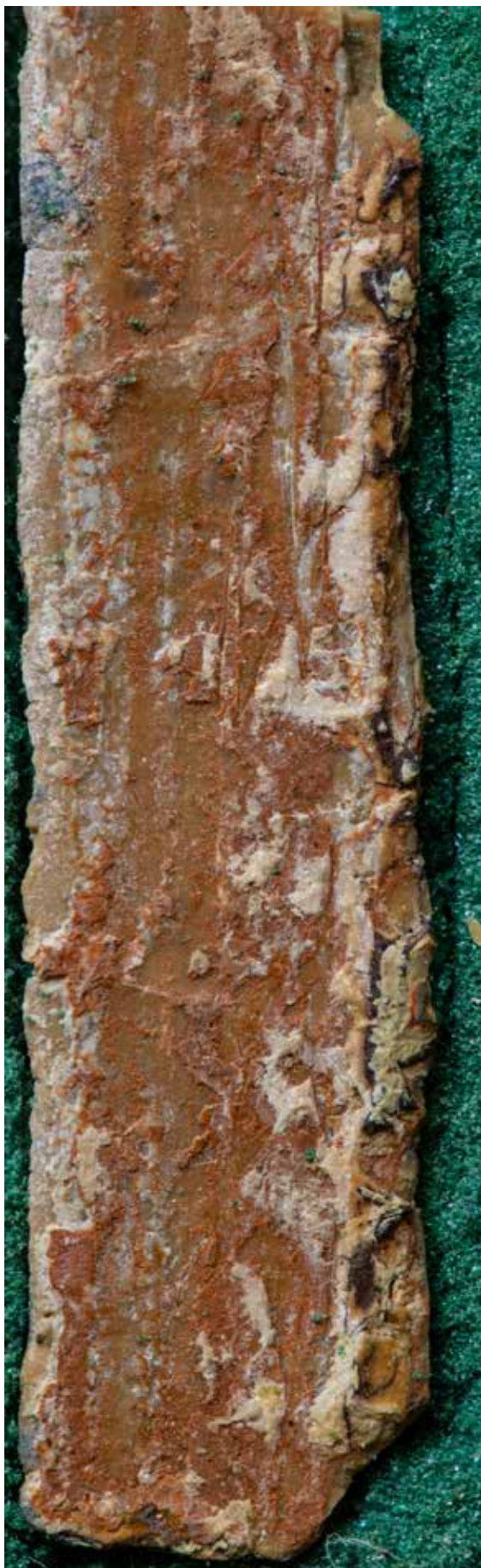
Prøver fra øvre vindusramme sal nord, kitt. Øverst til høyre nedsiden/baksiden av yngre kitt lagt utenpå opprinnelig kitt med tidlig maling.
