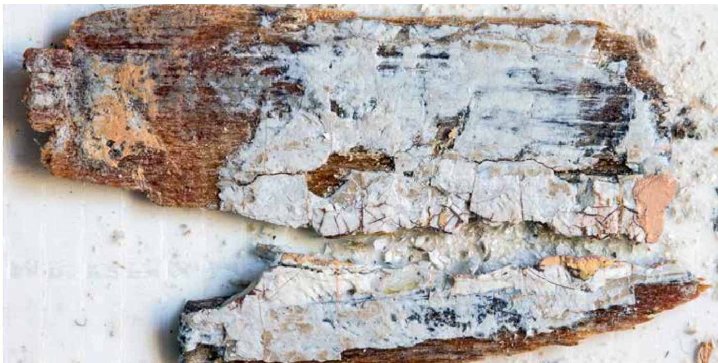
Vindu sal nord 2 etg. Sidegerikt. Prøve 006 0 Treverk 1 s3005-Y50R / s3000-N grunning 2 s 2500-N / man: s1500-N / s2000-N 33020-Y50R
